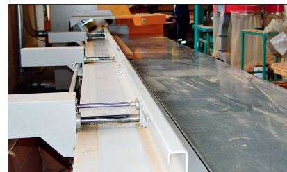
Klapptisch am Auslauf der mit der Diele in die Horizontale kippt. Mit Schiebern wird das Werkstück hydraulisch abgelegt.
