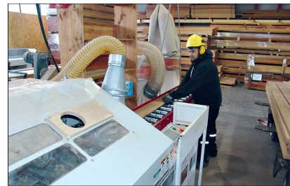
Ebenfalls neu sind die Breitbandschleifmaschine „Sandomat 650“ und der „Endmatcher 300“ zum Bearbeiten der Stirnseiten.
