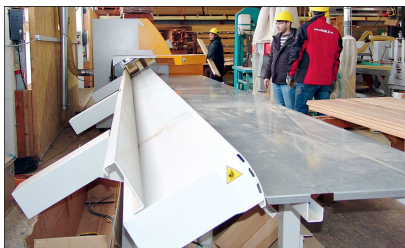
Klapptisch am Auslauf der mit der Diele in die Horizontale kippt. Mit Schiebern wird das Werkstück hydraulisch abgelegt.
