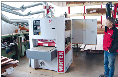
Ebenfalls neu sind die Breitbandschleifmaschine „Sandomat 650“ und der „Endmatcher 300“ zum Bearbeiten der Stirnseiten.
