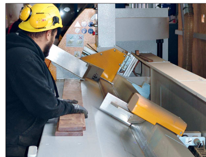
Die für 6,2 m lange Werkstücke ausgelegte Auflagefläche ist im Winkel von 30° schräg angeordnet. So können ganz ohne mechanische Hilfe, einfach der Schwerkraft folgend, mehrere Dielen parallel aufgelegt werden, die dann nachrutschen, wenn der automatische Schieberschlitten die erste Diele mitgenommen hat.
