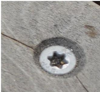
Bei zu starkem Eindrehen der Schraube, oder nicht sachgerechter Verschraubung gemäß der Verlegeanleitung, kann das Holz am Schraubloch einreißen.
