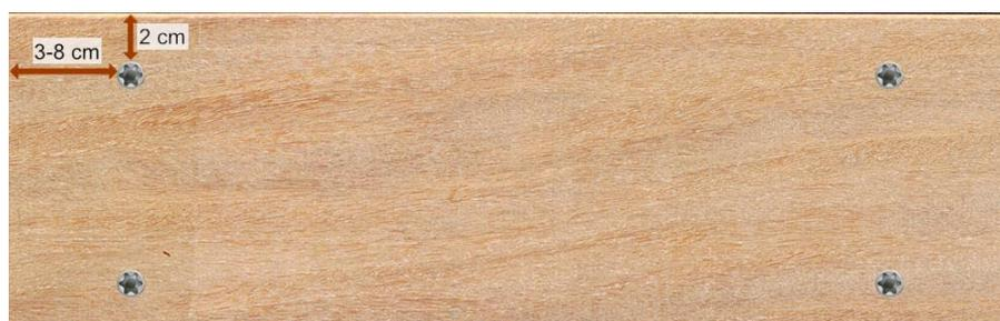
Schraubenempfehlung bei Verwendung einer Holzunterkonstruktion 45x70mm:
